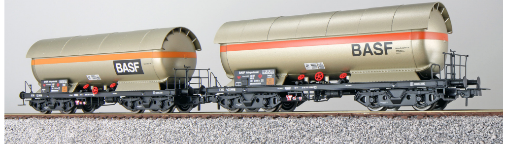
36535 , Gas-Kesselwagen-Set, H0, ZAG 620, DB, perlbeige, Ep. IV, BASF 33 80 781 6 098-7 + BASF 33 80 781 6 101-9, DC
